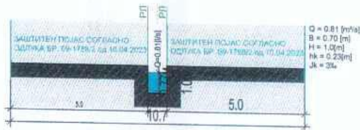
M=1:100 УСВОЕН НАПРЕЧЕН ПРЕСЕК НА КОРИТО НА „ДОЛ ЖИТЕН СКЛАД“ - ПРАВОГОЛЕН ПРОФИЛ - согласно „Хидролошка студија за регулација на водотеци за Генерален урбанистички план во Крива Паланка, општина Крива Паланка“ - 2022год.
