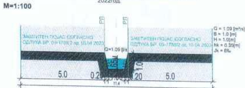
M=1:100 УСВОЕН НАПРЕЧЕН ПРЕСЕК НА КОРИТО НА „ИЦЕВ ДОЛ“ - ТРАПЕЗЕН ПРОФИЛ - согласно „Хидролошка студија за регулација на водотеци за Генерален урбанистички план во Крива Паланка, општина Крива Паланка“ - 2022год.
